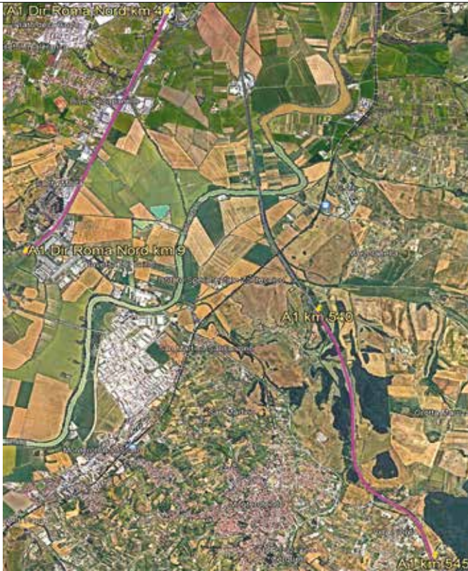
1. I tracciati di riferimento per le misure di CAT, MPD e IRI
